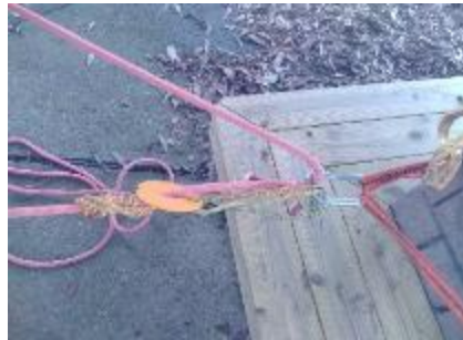
1/6 引き上げ、クレムハイスノットでブレーキをかける。
